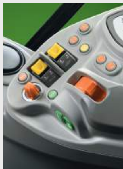
↑ Elektrohidravlični vklop sprednje in zadnje kardanske gredi in funkcija AUTO PTO.
